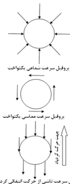
شکل ۲ پروفیل‌های سرعت مماسی و شعاعی پروفیل سرعت جریان ورودی به محفظه ناشی از حرکت انتقالی
