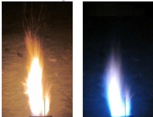
شکل ۲ تصویر شعله (الف) بدون تزریق و با تزریق ذرات زغال سنگ (ب)
