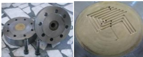
شکل ۵ مجموعه قالب ساخته شده برای شکل‌دهی شیرهای تکرارشونده
