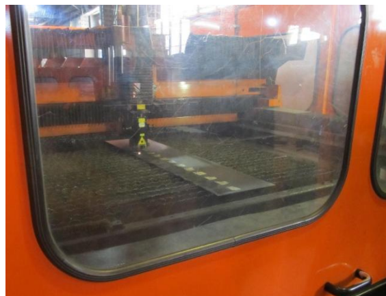
شکل 15 ورق‌های آلومینیم در حین فرآیند
