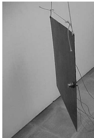
شکل 10 صفحه فلزی تحت آزمایش مودال محیطی به همراه جرم اضافی
