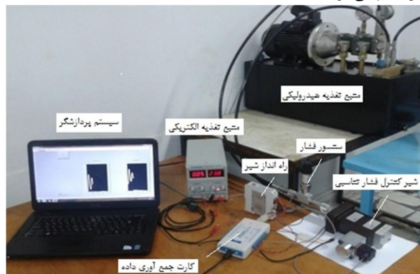
شکل 2 تجهیزات سخت‌افزاری مورد استفاده و نحوه ارتباط آنها با یکدیگر
