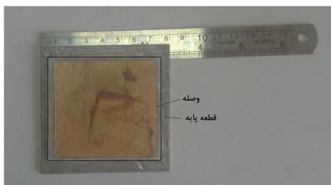
شکل 3 نمونه ترمیم شده آلومینیومی شیاردار
