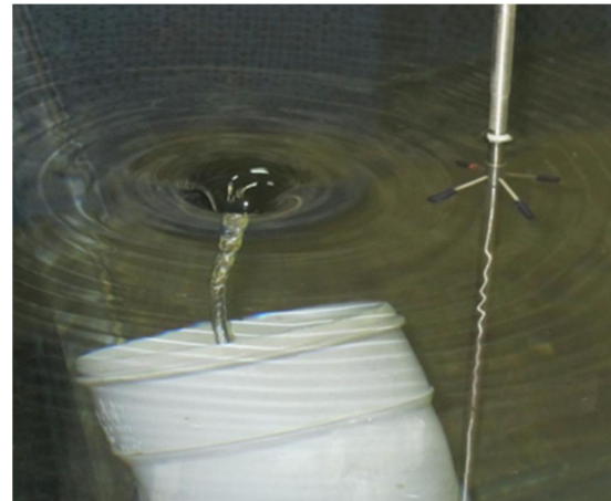
شکل 4 اندازه‌گیری سرعت مماسی گرداب به‌وسیله دستگاه سرعت‌سنج ADV
