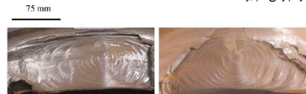
شکل ۱ شکست دو چرخ فولادی قطار در اثر رشد ترک زیرسطحی بیضوی [۸]
