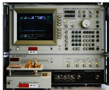
شکل 14 دستگاه تحلیلگر بهره امیدانس
