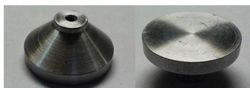
شکل 10 دو نما از جرم سر آلومینیومی
