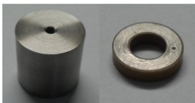
شکل 11 جرم دنباله فولادی (سمت راست) و رینگ پیزوسرامیک (سمت چپ)
