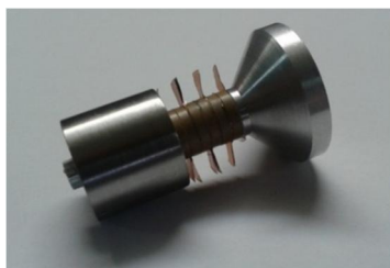
شکل 13 ترانسدیوسر تانپیلز با ورق‌های پلی استر
