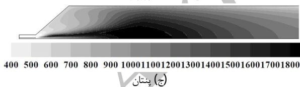
شکل 9 کانتور دما در نسبت هم‌ارزی 1/1 برای سوخت‌های متان، پروپان و پنتان
