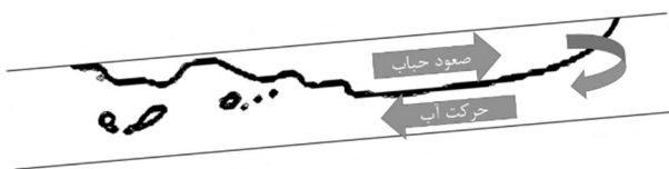
شکل 7 طرحواره حرکت آب و هوا در صعود حباب تیلور در کانال شیب‌دار
