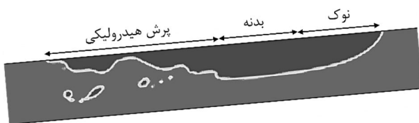
شکل 5 اجزا تشکیل دهنده حباب تیلور در شیب 5 درجه
