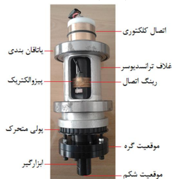
شکل 1 سیستم انتقال ارتعاش اولتراسونیک
