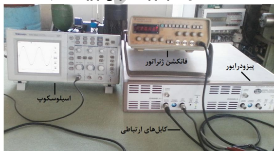
شکل 4 تجهیزات تست و تنظیم فرکانس
