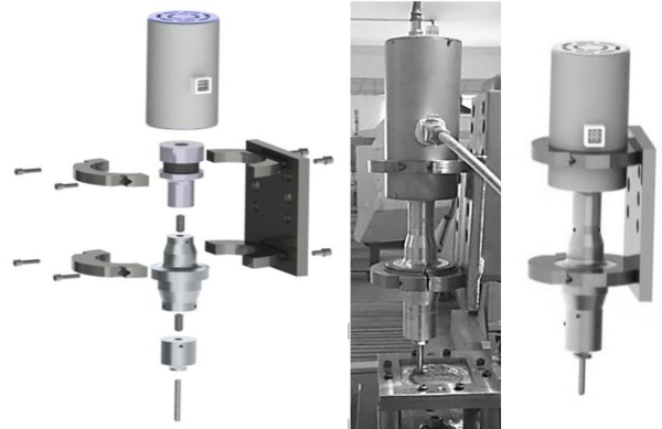
شکل 7 کنگی شکل‌دهی افزایشی با امواج آلتراسونیک
