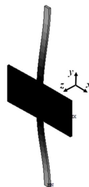
شکل 2 مد اول ارتعاش تشدیدگر مستطیلی میکرومکانیکی با دو تیر نگهدارنده قائم، مد شناور
