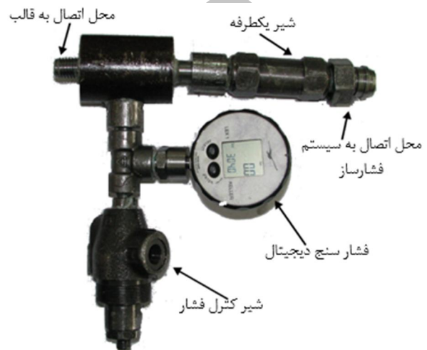
شکل 7 تجهیزات سیستم هیدرولیک کنترل فشار
