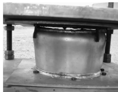
شکل 17 پارگی در محل اتصال ورق به پوسته
