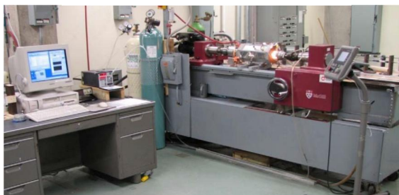
شکل 2 دستگاه پیچش گرم مجهز به رایانه [13].
