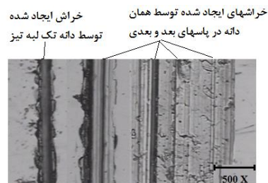
شکل 5 سیر تکاملی شکل خراش‌ها در تست خراش تک‌دانه (شکل دانه برشی به دلیل سایش دانه تغییر می‌کند)
