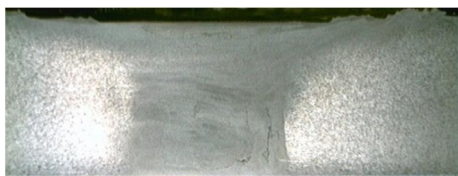
شکل 6 مقطع جوش برای ابزار با شانه 20 میلی‌متر
