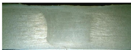
شکل 7 مقطع جوش برای ابزار با شانه 26 میلی‌متر
