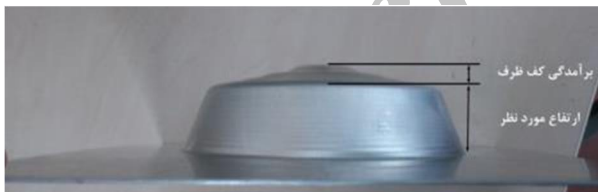
شکل 5 برآمدگی کف ظرف در شکل‌دهی تدریجی چهار مرحله‌ای بر اساس استراتژی متداول
