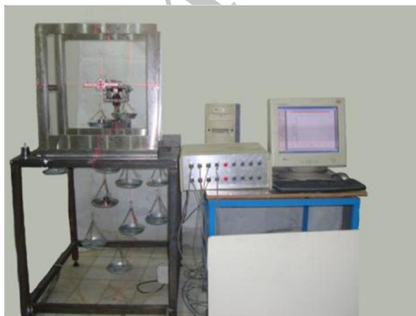
شکل 14 سیستم کالیبراسیون بالانس نیرو گشتاور
