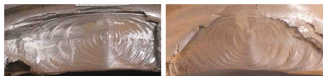
شکل 1 شکست دو چرخ فولادی قطار در اثر رشد ترک زیرسطحی بیضوی [2]
