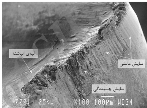
شکل 10 تصویر SEM مربوط به ابزار برشی در سرعت 70 m/min و پیشروی 0/15 mm/rev
