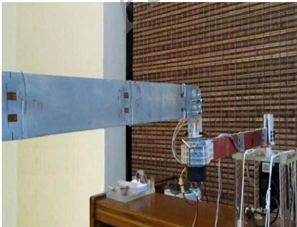
شکل 2 ربات دو لینکی انعطاف‌پذیر ساخته در آزمایشگاه تحقیقاتی رباتیک دانشکده مهندسی مکانیک دانشگاه علم و صنعت ایران
