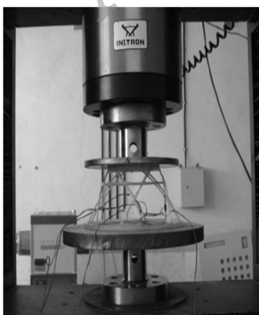
شکل 12 آزمایش فشار محوری پوسته مشبک مخروطی
