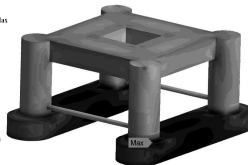
شکل 8 نمایی از توزیع کرنش معادل در کل سکوی حفاری نیمه‌شناور امیر کبیر
