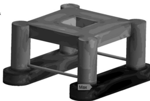
شکل 7 نمایی از توزیع تنش فون مایز در کل سکوی حفاری نیمه‌شناور امیر کبیر
