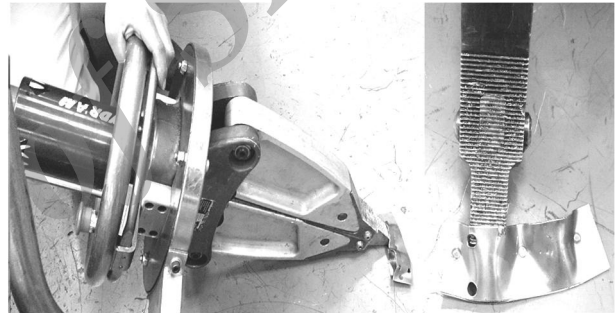
شکل 3 تست استاتیکی نمونه با قیچی تخریب
