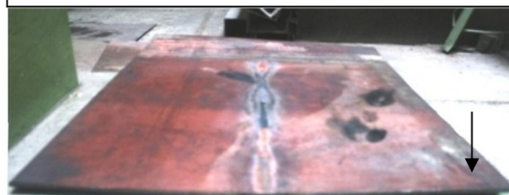
شکل 4 انحنا ورق بعد از پاس حرارتی اول
