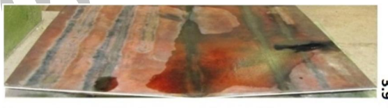
شکل 5 انحنا ورق بعد از پاس حرارتی اول
