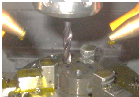
شکل 5 نمایی از آزمایش‌های سوراخ‌کاری معمولی
