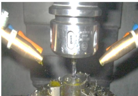
شکل 4 نمایی از آزمایش‌های فرزکاری مارپیچ
