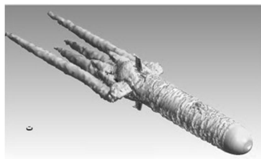
شکل 16 شکل گیری ساختارهای گردابه‌ای در پشت ربات در سرعت 1/5 متر بر ثانیه در زوایای استرن مختلف: الف) 0 درجه، ب) 10 درجه، پ) 20 درجه، ت) 35 درجه، ث) 45 درجه.
