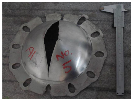
شکل 10 حالت واماندگی III (تغییر شکل پلاستیک با پارگی موضعی در مرکز ورق)
