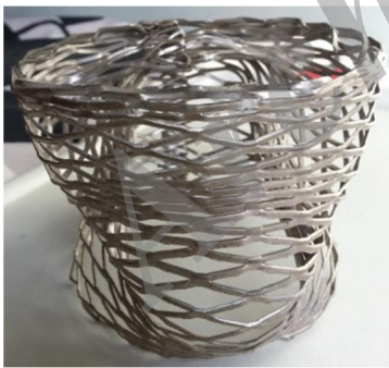
شکل 25 نحوه بسته شدن سلول‌ها روی یکدیگر بعد از فروریزش ( \alpha=0 )
