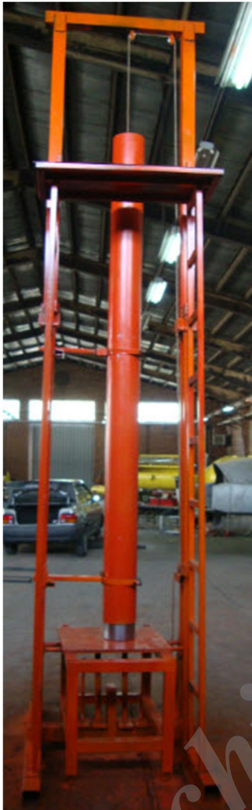
شکل 4 نمای کلی دستگاه ضربه‌زن سقوط آزاد
