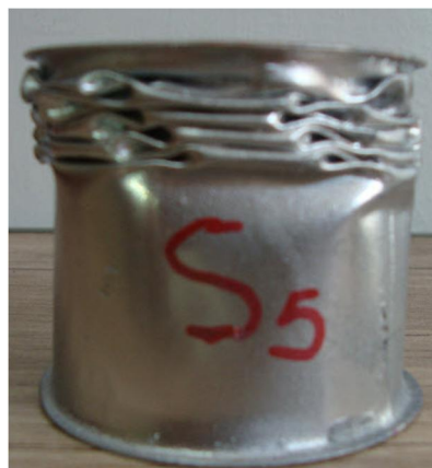
شکل 11 نمای جاذب S5 بعد از آزمایش ضربه
