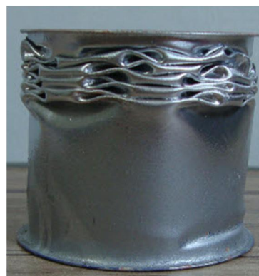
شکل 6 شکل چین‌خوردگی بالایی لوله
