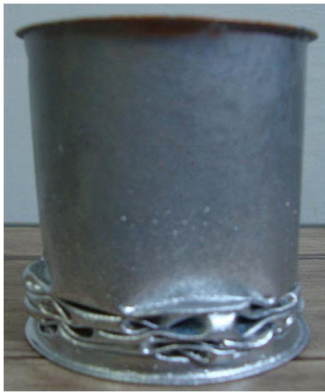
شکل 7 شکل چین‌خوردگی پایینی لوله
