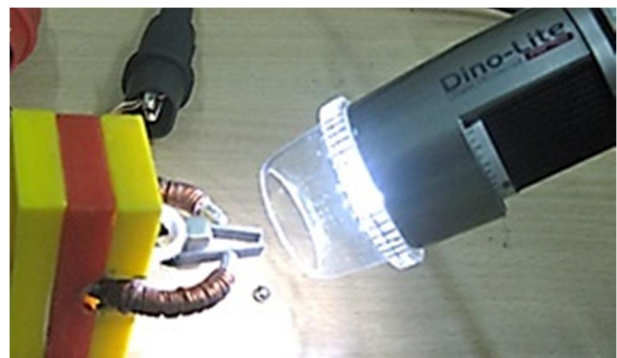
شکل 14 اندازه گیری میکروسکوپی زاویه انحنای تیرهای فک گریپر مینیاتوری
