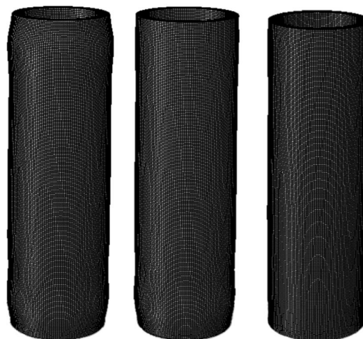
شکل 6 نمایش سه بعدی پوسته کمانش یافته برای حالت‌های 1، 2 و 3 در سرعت 120 متر بر ثانیه بر اساس نرم‌افزار آپاکس
