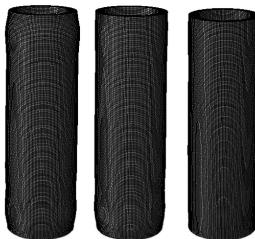
شکل 6 نمایش سه بعدی پوسته کمانش یافته برای حالت‌های 1، 2 و 3 در سرعت 120 متر بر ثانیه بر اساس نرم‌افزار آباکس
