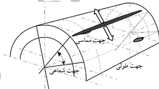
شکل 19 ایجاد ترک‌های طولی در سطح خارجی لوله‌های تولید شده با فرآیند پیلگر سه غلتکه [11]
