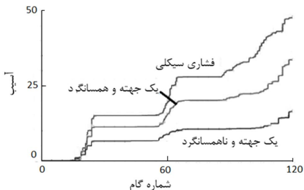
شکل 16 مقایسه میزان آسیب مدل کاکرافت-لاتم با قوانین ساختاری متفاوت [11]
