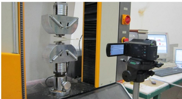
شکل ۲ آزمون شبه استاتیکی رشد جدایش بین لایه‌ای، تحت بارگذاری مود ۱
