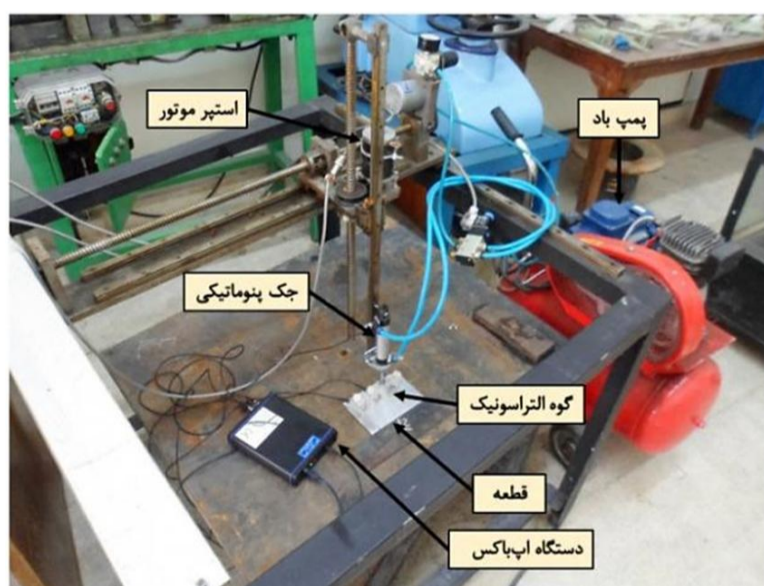
شکل 6 تجهیزات مورد استفاده در روش التراسونیک
