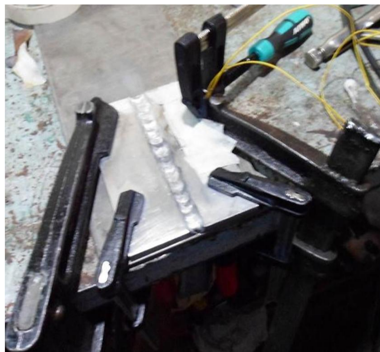
شکل 1 شرایط و قیدوبندهای جوش کاری
