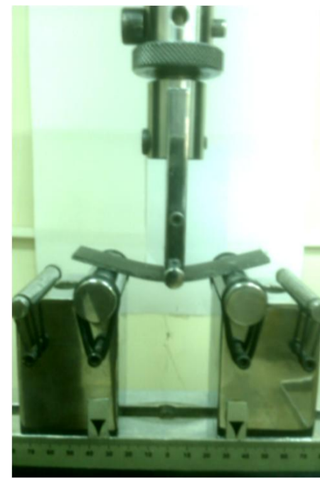
شکل 8 یک نمونه از آزمایش خمش سه نقطه
