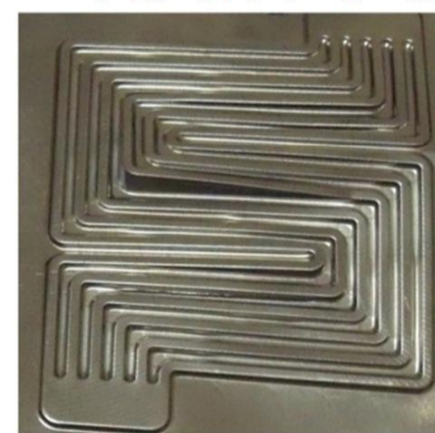
شکل ۷ پارگی در کانال‌های ورق
