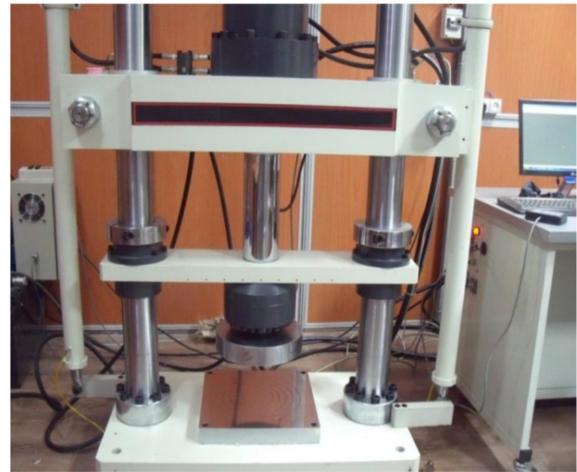
شکل ۴ دستگاه پرس استفاده شده جهت اعمال نیرو به قالب
