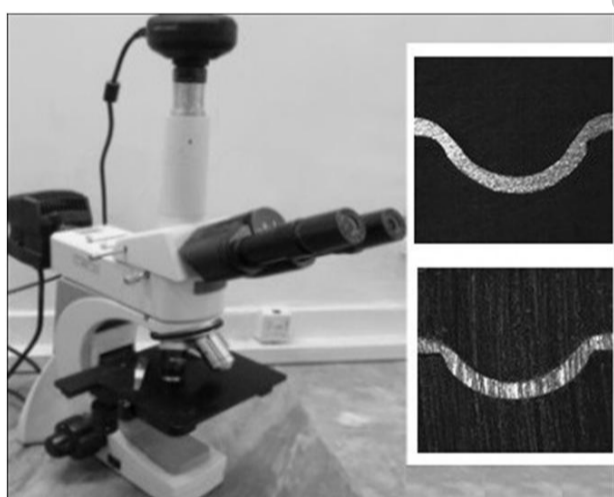
شکل 6 اندازه‌گیری میکروسکوپی مقاطع در بررسی پروفیل پرشدگی
