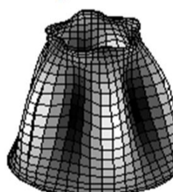
شکل 6 تأثیر شرایط مرزی بر شکل کمانش حرارتی پوسته مخروطی ساخته شده از نانو کامپوزیت‌های هدفمند ( UD, v_{cn}^* = 0.17, \beta = 30^\circ, \frac{L}{R_1} = 2, \frac{R_1}{h} = 40 )
