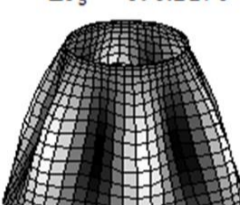
شکل 5 شش مدل کمانش حرارتی پوسته مخروطی ساخته شده از نانو کامپوزیت‌های هدفمند ( SS, FGX, v_{cn}^* = 0.28, \beta = 30^\circ, \frac{L}{R_1} = 2, \frac{R_1}{h} = 20 )
