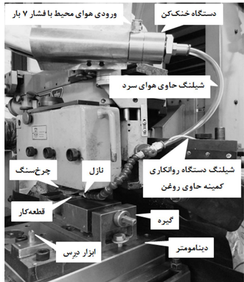
شکل 3 چیدمان تجهیزات مورد استفاده در انجام آزمایش‌های سنگزنی
