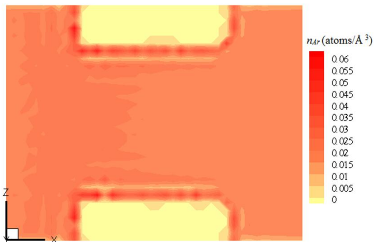
شکل 8 توزیع چگالی سیال برای حالتی که مجرای رابط شعاع 22/5 آنگسترم دارد.
