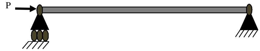
شکل 1 تیر تحت بار دینامیکی
