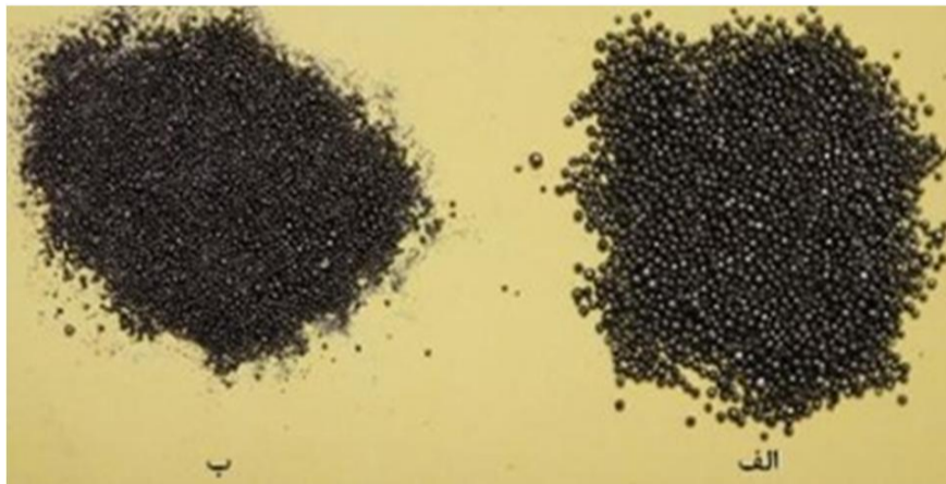
شکل 1 ساچمه‌های فولادی به کار رفته در آزمایش، الف) قطر d = 0/6 mm، ب) قطر d = 0/4 mm
