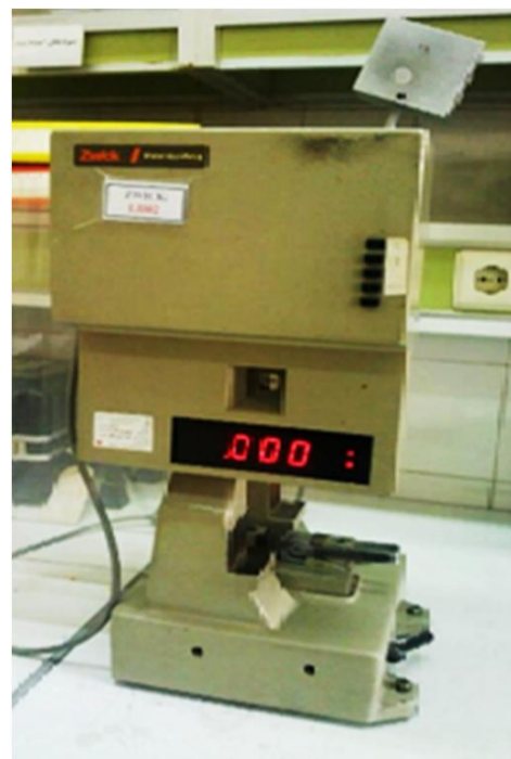
شکل 3 تصویر دستگاه آزمون ضربه
