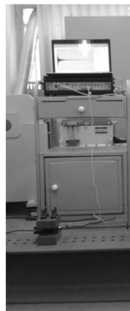
شکل 9 استخراج پاسخ ارتعاش تیر فولادی با شتابسنج پیزوالکتریک Type4507 شرکت B&K و دستگاه داده‌برداری چهار کاناله Type 3109
