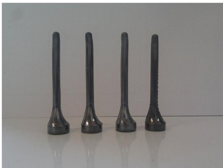
شکل 12 قطعات اکسترو شده با دمای قالب متفاوت - دمای قالب به ترتیب از سمت چپ 400 ، 425 ، 450 ، 475
