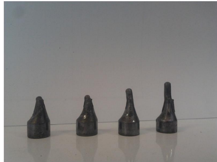
شکل 13 قطعات ناموفق با دمای قالب متفاوت - دمای قالب به ترتیب از سمت چپ 375 ، 400 ، 425 و 500
